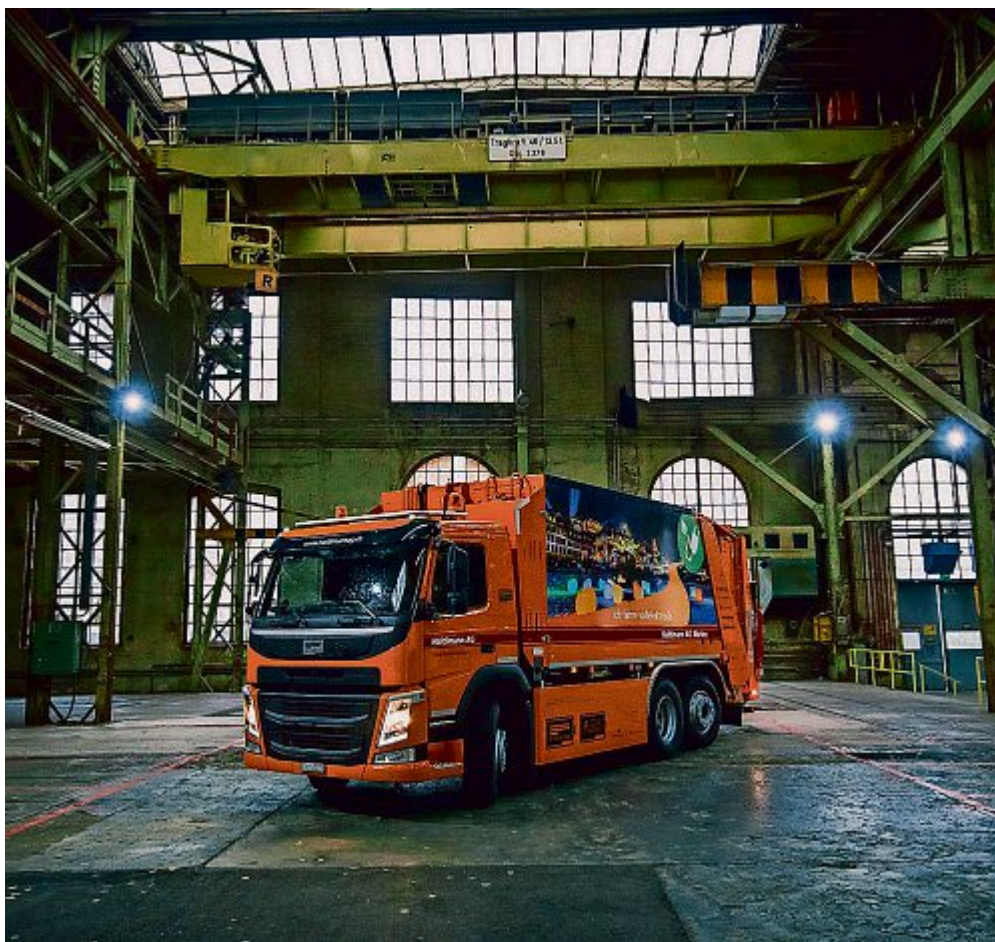
Von Designwerk entwickelt und von der Stadt Winterthur für die Müllabfuhr bestellt: Der geräuscharme- und emissionslose Elektrolastwagen Futuricum 26E. Mit 680 PS Leistung, 380 km Reichweite und bis 18,8 t Nutzlast setzt er neue Massstäbe.
